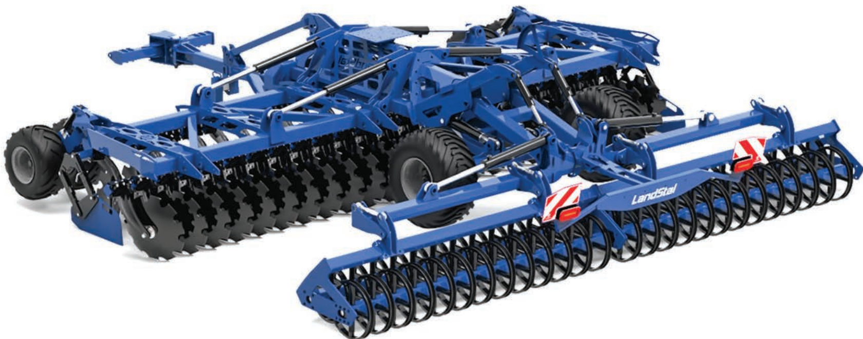
Прицепная дисковая борона с гидравлическим складыванием
