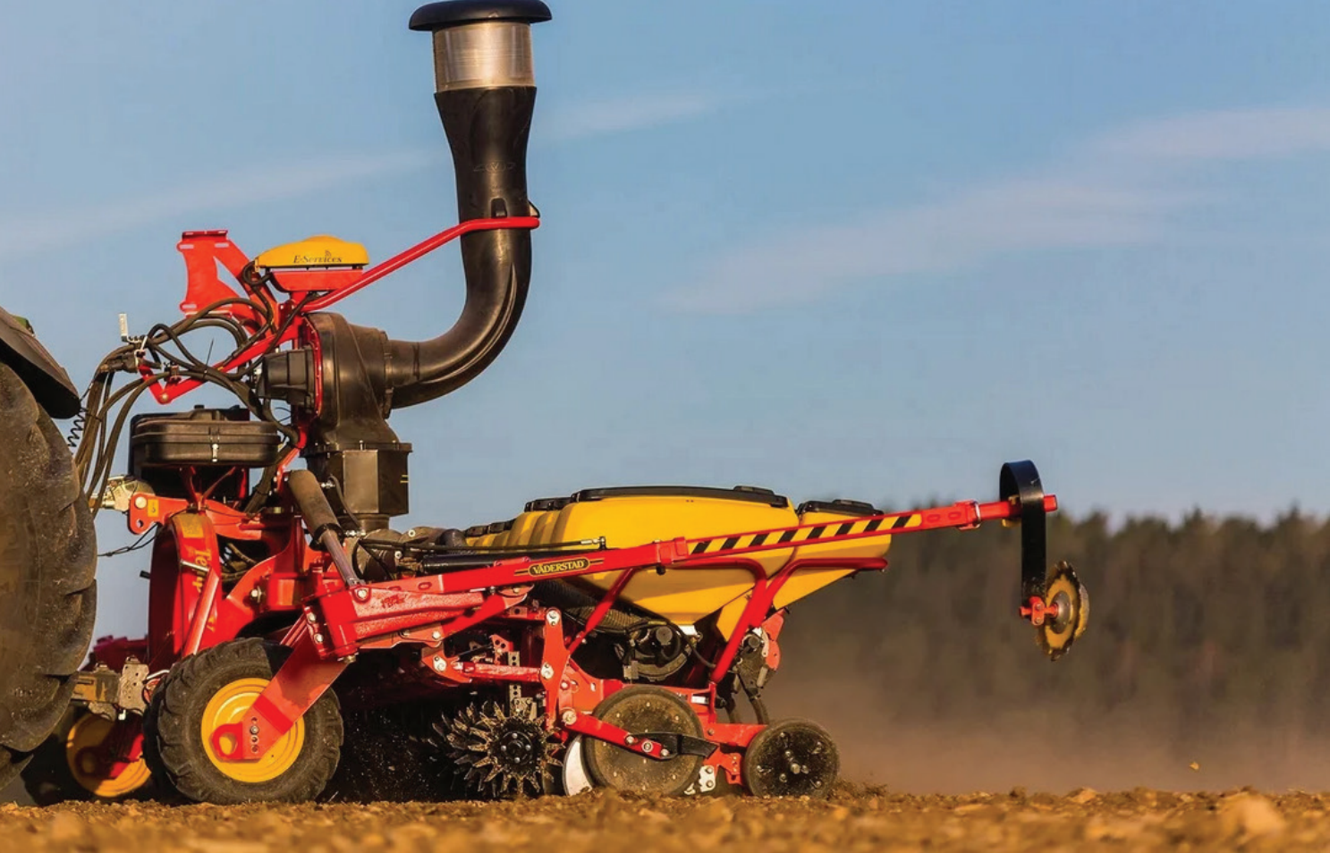
Пневматическая сеялка точного высева
