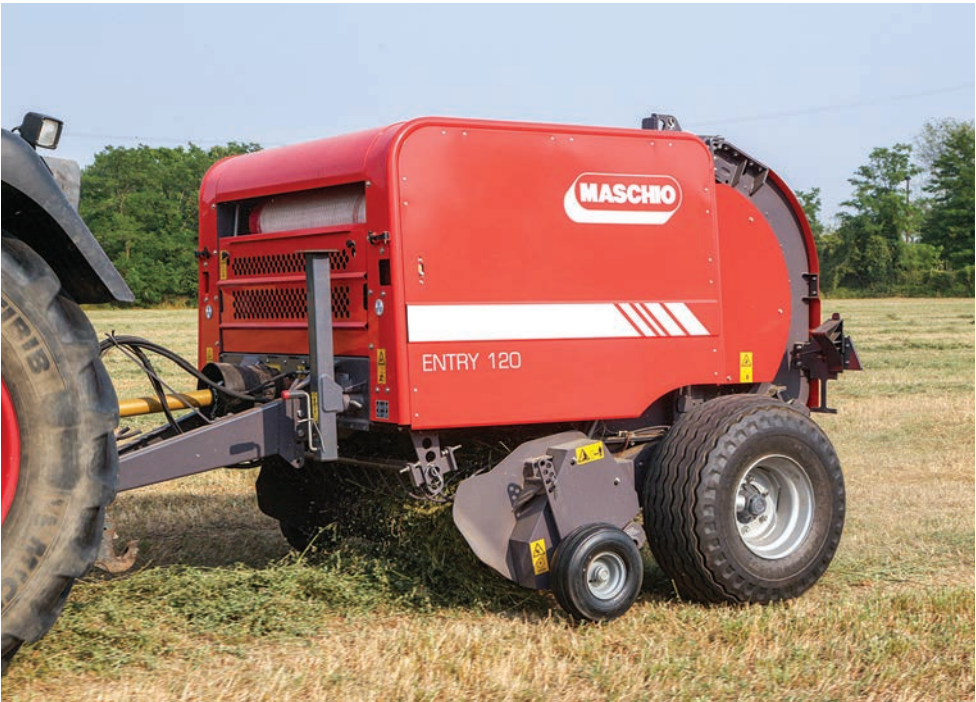
Пресс-подборщик с фиксированной камерой
